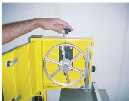
Soltar a guia de segurança, que se encontra na parte inferior da mesa, e em seguida retire a lâmina, conforme fig. 9 .
