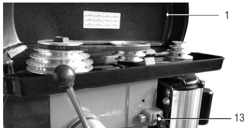
Figura 15 – Parafuso de trava e tensão da correia
