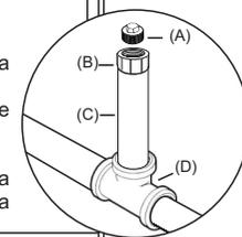
INSTALAÇÃO DE PRESSURIZAÇÃO EXTERNA (CISTERNA) IDEAL PARA TORNEIRA NO JARDIM, NO QUINTAL OU ABASTECIMENTO RÁPIDO DA CAIXA D'ÁGUA
