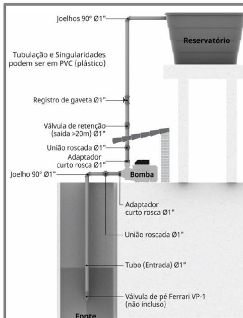
**Nota:** Sempre que for ligar a bomba, faça a escorva que é o processo de retirada de ar da bomba e da tubulação de sucção (entre a fonte e a bomba).
